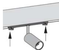
Click&Safety Lock Fissaggio meccanico di sicurezza
